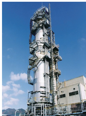
原材料の木材チップを炊く釜です
