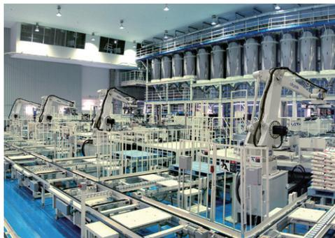
ロボットパレタイザを含む積み付け設備
